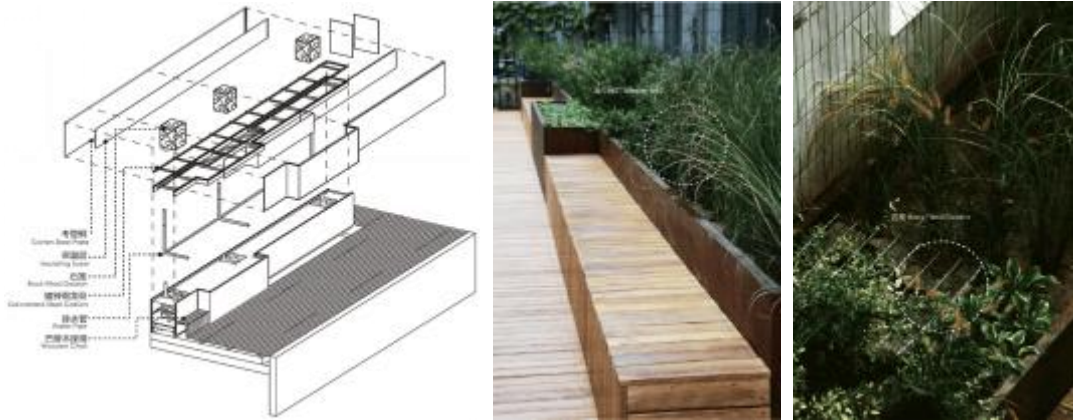
图 C. 1. 1-2 高位植坛构造及实施效果
