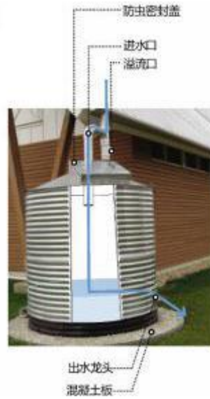
图 E. 10-5 储水罐构造示意图
